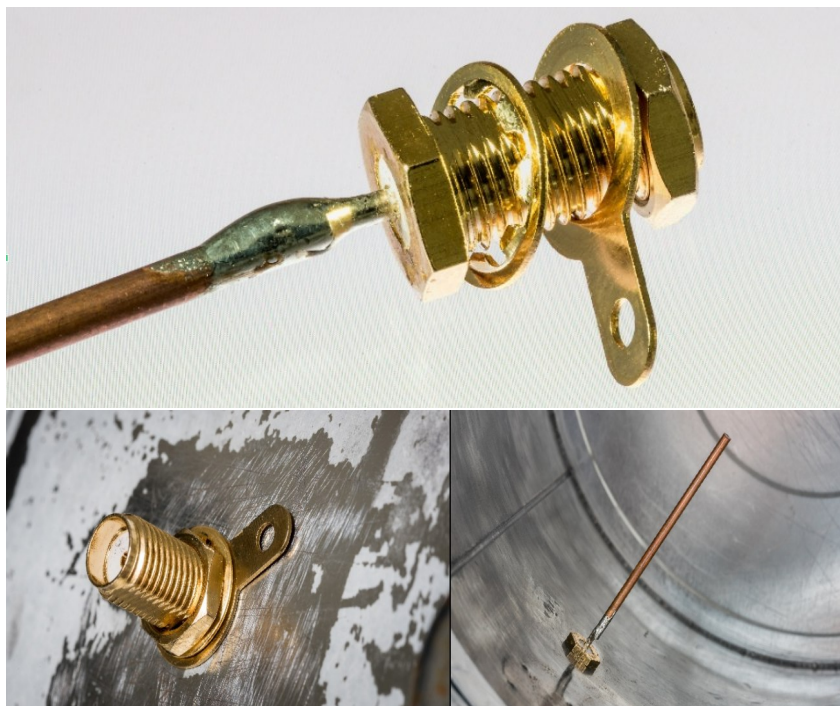
Рисунок 7. Установлення антени в банку
